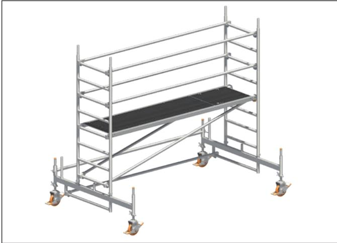
1. Die Lenkrollen **1** in die Fahrbalken **7/8** einstecken und durch Festdrehen der Flügelschrauben an den Spindelmuttern gegen Herausfallen sichern.
