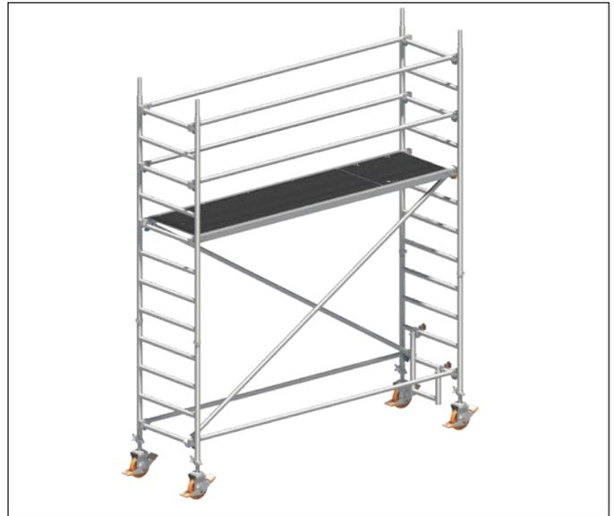
1. Die Lenkrollen **1** werden in die 1,00-m-Standleitern **14** eingesteckt und durch Festdrehen der Flügelschrauben an den Spindelmuttern gegen Herausfallen gesichert.
