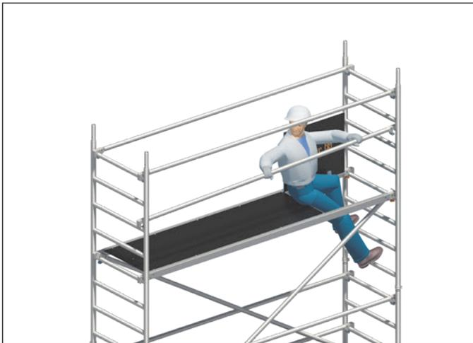
5. Innenseitiger Aufstieg über die Sprossen der Standleiter durch die dafür vorgesehene Durchstiegsklappe. In der Durchstiegsöffnung sitzend, absturzesichert durch die Holme der Durchstiegsbrücke **26**, erfolgt die Montage des Zwischengländers der nächsten Lage, hierzu werden die Geländer **15** an den zweiten Sprossen über der Standfläche montiert.
