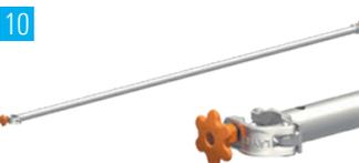
**1324.285** Basisstrebe 2,85 m mit 2 Halbkupplungen, Stahlrohr feuerverzinkt, Länge 2,85 m, Gew. 9,3 kg.
