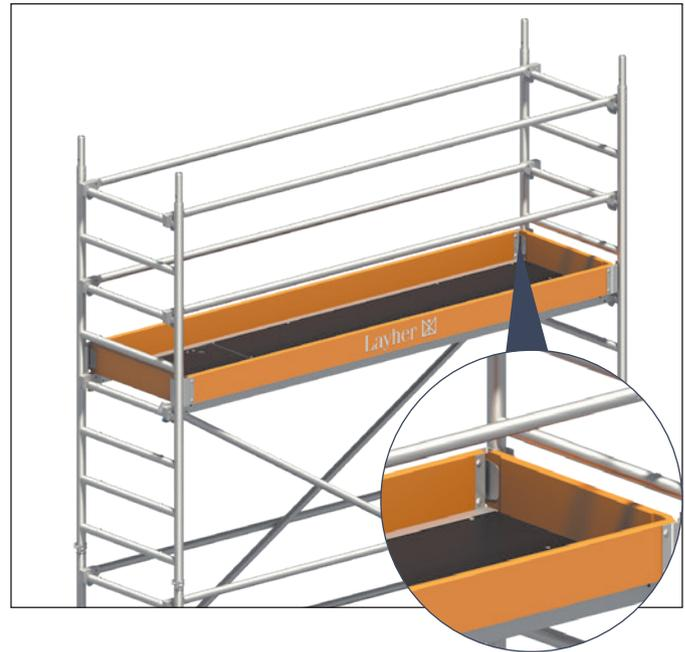
1. Zum Abschluss der Arbeitsbühne müssen Bordbretter mit Klau**30** und Stirnbordbretter **31** angebracht werden.
