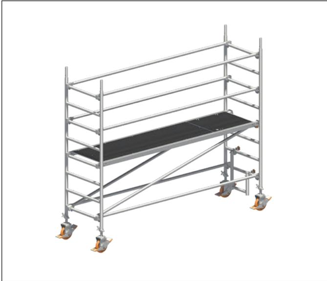
1. Die Lenkrollen **1** werden in die 2,00-m-Standleitern **15** eingesteckt und durch Festdrehen der Flügelsschrauben an den Spindelmuttern gegen Herausfallen gesichert.
